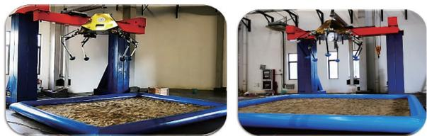
图 12 探月四足和六足飞跃机器人着陆实验
